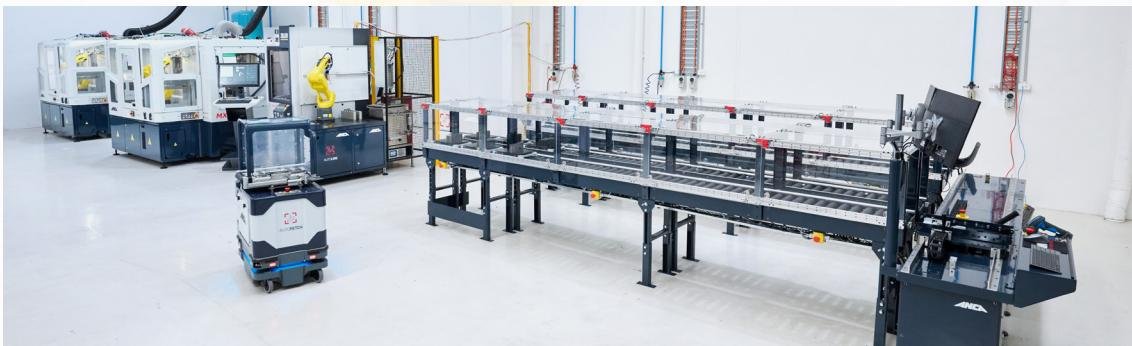
AIMS (ANCA Integrated Manufacturing System) verändert die Werkzeugherstellung mit seinen modularen, flexiblen Aufbau. Durch die Kombination von MES-Funktionen (Manufacturing Execution System) mit Auftragsmanagement und Produktionskontrolle entsteht ein nahtloses, effizientes Ökosystem, das die Produktivität steigert, die Abhängigkeit von Arbeitskräften reduziert und Fehlerraten minimiert.
