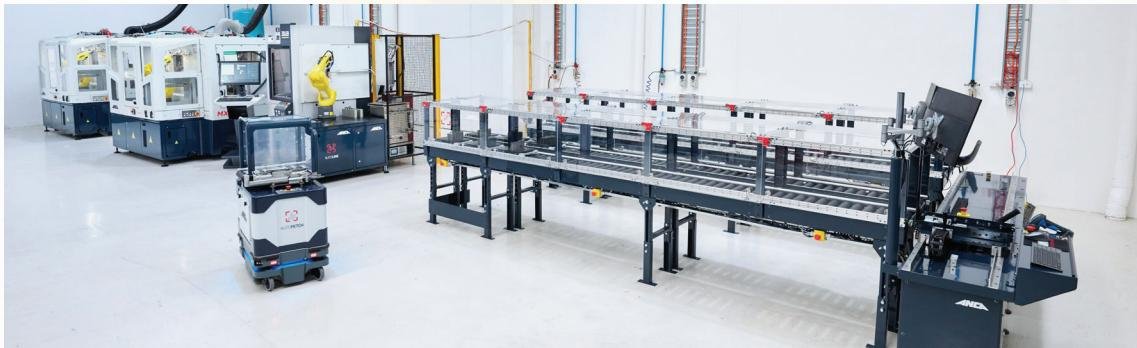
AIMS (ANCA集成制造系统)凭借其模块化和灵活的设计,正在改变工具制造。通过将制造执行系统(MES)的功能与作业管理和生产控制相结合,它创造了一个无缝、高效的生态系统,从而提高生产力、减少对劳动力的依赖并最大限度地减少浪费。
