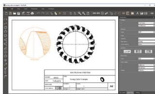
ToolDraft dient der Erstellung von 2D-Zeichnungen für Schneidwerkzeuge aus einem simulierten Werkzeug oder direkt aus ToolRoom. Es baut auf der Grundlage der CIM3D-Engine auf, die ein 3D-Modell in genaue 2D-Projektionsansichten projiziert. Dies hilft Kunden, Zeichnungen von Schneidwerkzeugen zu erstellen, die auf ANCA-Maschinen hergestellt werden, ohne auf Software von Drittanbietern angewiesen zu sein.
