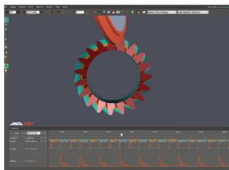
Die Möglichkeit, den Schleifprozess mit der patentierten CIMulator3D-Software von ANCA vollständig zu simulieren, bedeutet, dass der gesamte Schleifvorgang sowie die endgültige Geometrie in 3D erstellt und visuell überprüft werden können. CIMulator3D bietet auch den Vorteil, dass eine Prozessoptimierung durchgeführt werden kann, wodurch die Maschinenauslastung maximiert und die Rüstzeiten weiter reduziert werden.
