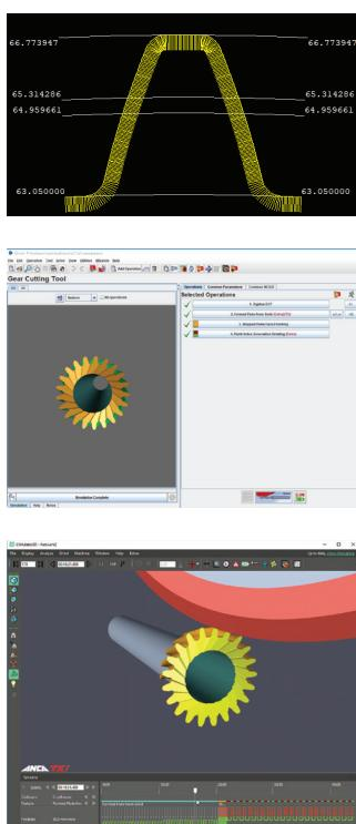
Das Softwarepaket der GCX Linear umfasst mehrere Softwarekomponenten für die Herstellung und das Nachschärfen von Zahnradzahnrädern. Es umfasst Konstruktion, Simulation, Schleifsequenzprogrammierung, Scheibenbearbeitung und -abrichtung, Werkzeugprofil- und Abstandsmessung, direkte Schleifbahnkompensation und unterstützt die vollständige Virtualisierung des Fertigungsprozesses.
