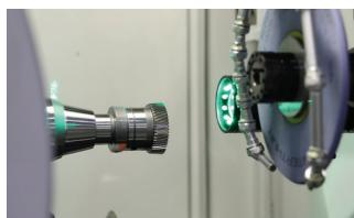
iView ist ein Messsystem, das in der Lage ist, das geschliffene Werkzeug zu messen, während es sich noch in der Werkstückaufnahme der Schleifmaschine befindet. Das von der iView-Kamera aufgenommene Bild des geschliffenen Werkzeugs wird mit einem idealen Overlay-Profil verglichen, das von der iView-Software erstellt wird.
