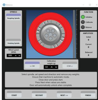
iBalance ist ein von ANCA entwickeltes Auswuchtsystem für perfekt ausgewuchtete Schleifscheiben. Es handelt sich um ein kostengünstiges System, da die iBalance-Software die bereits in der Maschine vorhandene Hardware nutzt.
