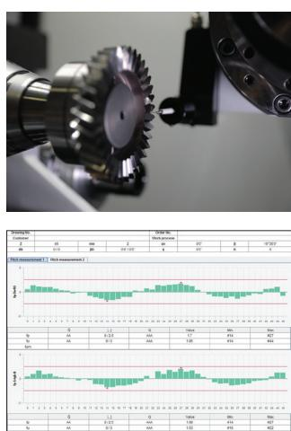
Aufgrund der Neuartigkeit des Schälfräzers haben viele branchenübliche GMMs (Gear Measurement Machines - Verzahnungsmessmaschinen) noch keine eingebauten mathematischen Modelle zur Bewertung des Schälfräserprofils entwickelt.
