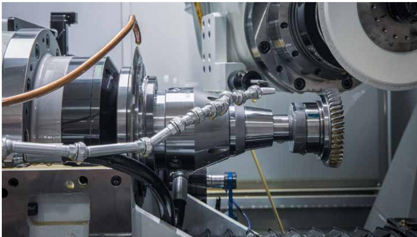
この Piranha 冷却システムは、まさに求めていた冷却システムを実現する新しい発想から生まれたフレキシブルでタフなソリューションです。高強度アルマイト製で、80 バールの圧力に耐えるように設計されており、ANCA 社の研削盤への取り付けが可能です。この Piranha 冷却システムは適応性に優れており、冷却剤を研削ポイントに的確に送り出すことが可能です。モジュール式の組み立て設計になっているためセットアップに時間が掛からず、高度なカスタマイズが可能となっています。
