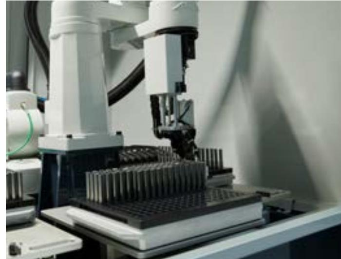
La macchina CPX è dotata di caricatore a basso costo AR300 di ANCA per il caricamento automatico di pezzi grezzi di utensili.
