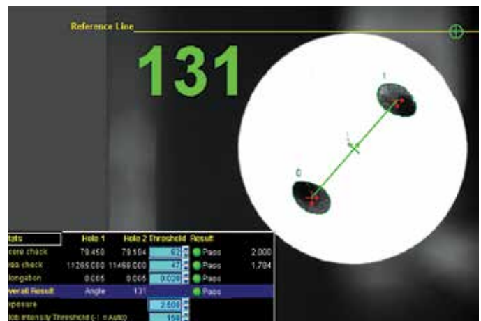
Die Spitze des Werkzeugs erscheint in weiß, während die beiden Kühlmittellöcher dunkel sind
