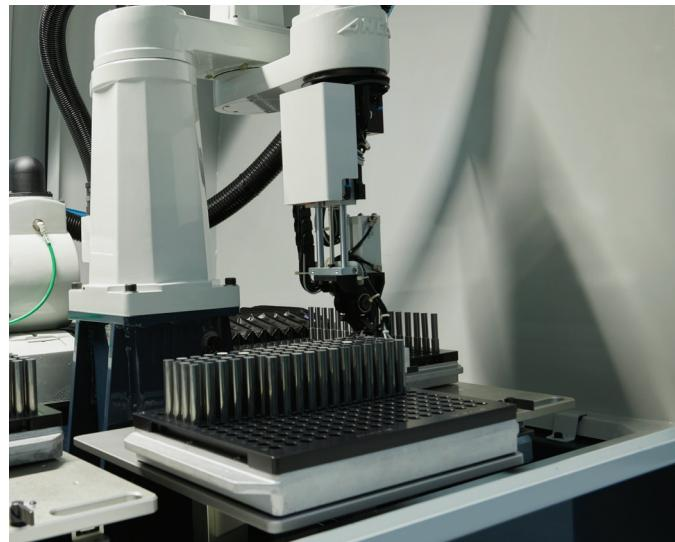
CPX使用ANCA生产的AR300型机器手，作为经济型上料机，棒料最大直径、长度为：20毫米 x 200毫米。
