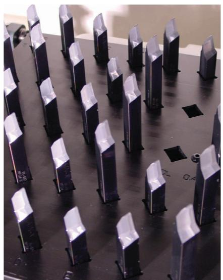
ANCA的RoboMate机器手上料机是多功能的灵活的自动化解决方案 使用Fanuc机器手的准确性和可靠性，RoboMate直接从毛坯工件料盘中抓取工件送到卡盘，磨完再从卡盘上取下送到成品料盘。
