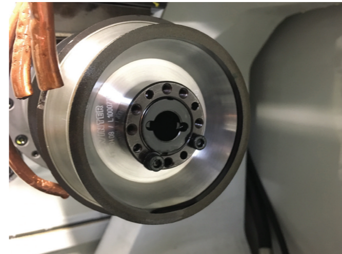
正确的转速下磨床内部的砂轮平衡
